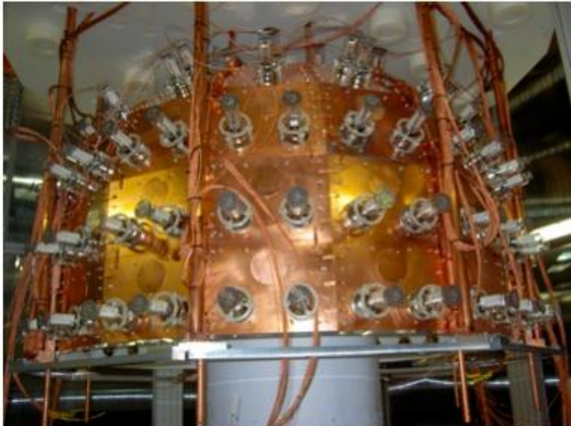
Fig. 2: Il sistema di fotomoltiplicatori di WArP – 100 l. The WArp – 100 l PMTs array.
